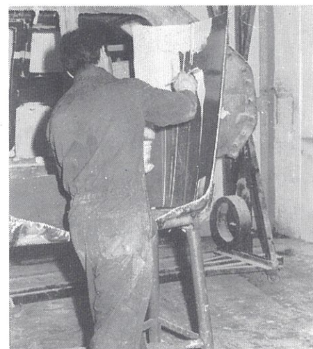
'Gelcoat' voor glad oppervlak.
